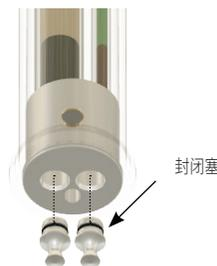
在移除封闭塞后,需要在1分钟内将过滤器安装在基板上,以防止周围空气中的氧气和湿气扩散到过滤器中。
